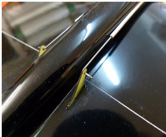
Avant de coller les 2 guignols, repercer les trous avec un foret de 1mm de diam, cela sera plus facile pour monter et démonter les ailes...
