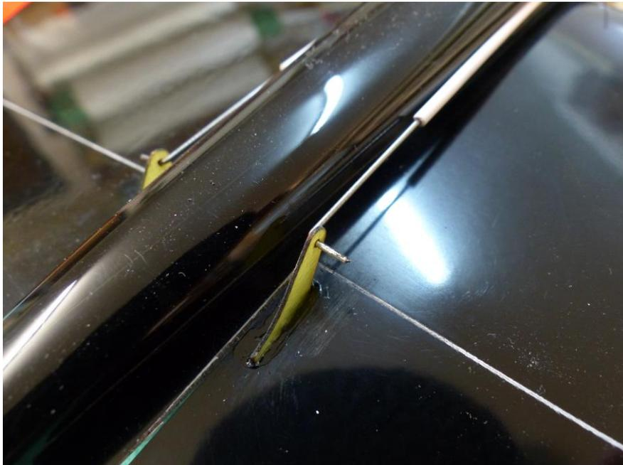
La cap dépasse de 5mm, inutile alors de sécuriser cette commande pour le vol. Bien pratique pour les montage/démontages !
