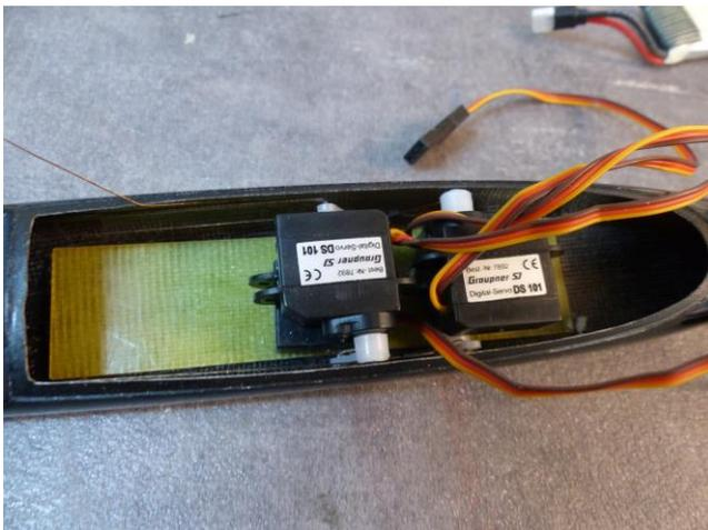
Le bloc « ailerons » vient contre celui des empennages ce qui laisse la place pour le récepteur
