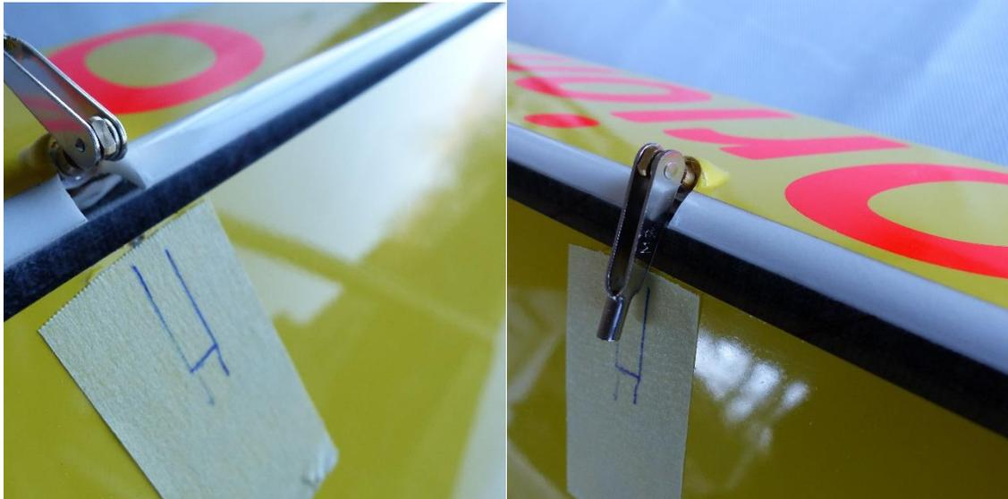
Pour tailler la fente : un disque de dremel, une petite fraise sont adaptés mais surtout, la fin du travail se fait avec la lime pour bien ajuster le passage de la chape. Le grand minimum est de 17mm de profondeur.
