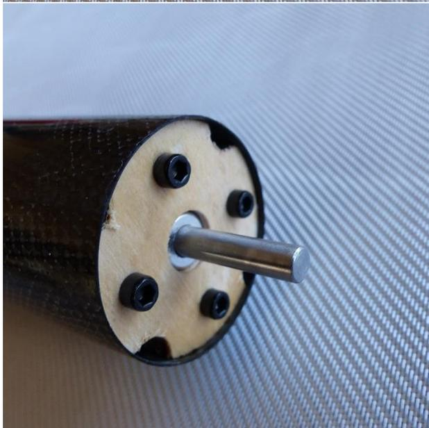
Le ctp 5mm du couple pourra être ajouré pour le passage de l'air. Faire un bon collage époxy entre le bout du fuselage et le ctp.
