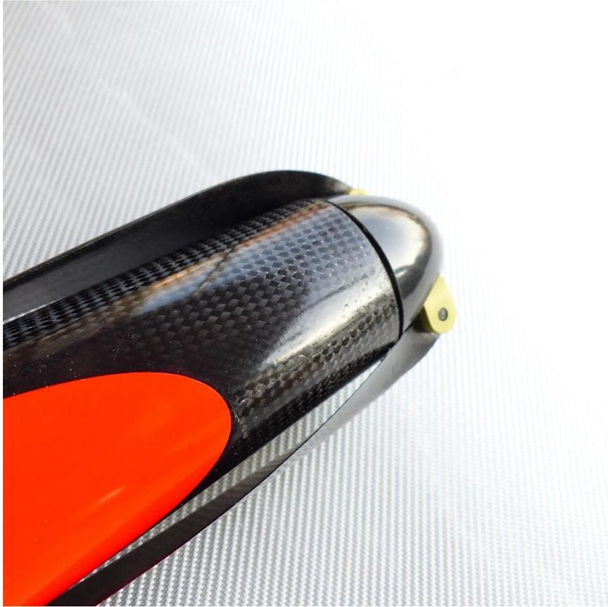
Il faut laisser 1 à 2mm entre le cône et le fuselage
