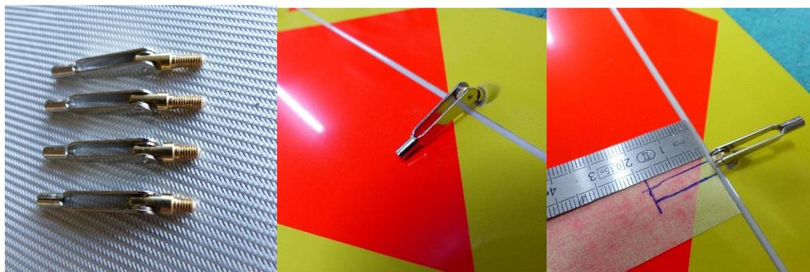
Profondeur des entailles à réaliser : 20mm pour l'aileron et 17mm pour les volets. Il est tout à fait normal qu'un petit longeron soit entaillé. Également, pour la commande des volets, il faut ajouter la lèvre blanche afin que le volet puisse aller vers le bas au maximum
