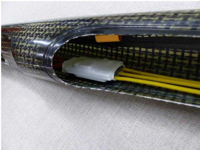
Fixation de la verrière : un classique du genre... une corde à piano 1.5mm collée dans le fond de la verrière
