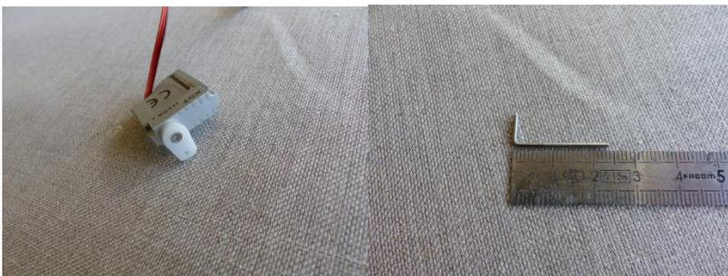
Également, pour faire au plus simple : il faut couper les pattes de fixation qui n'ont aucune utilité et préparer un palonnier en utilisant le trou qui est à 10mm de l'axe de rotation. La commande du volet de profondeur est une cap 12/10 de 23/25mm de longueur environ pliée à 90° sur 8mm environ.
