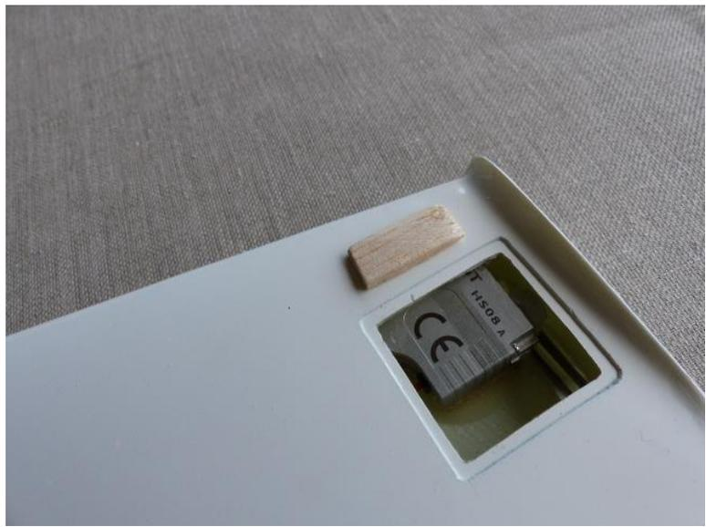
Le neutre du volet s'obtient en positionnant au bon endroit le servo, collage à l'époxy 5mn. Une deuxième cale en balsa placée entre le servo et le flanc supérieur de la dérive termine le collage.
