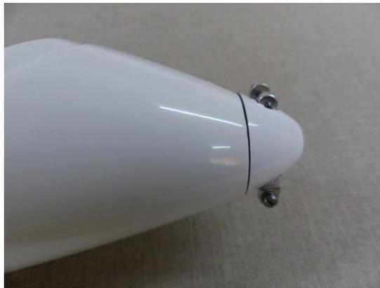
cône scale, 1.5mm entre le fuselage et le cône
