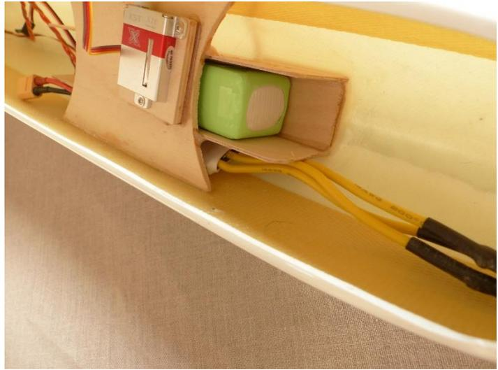
Le contrôleur trouve sa place entre le flanc de fuselage et le tunnel de la batterie lipo
