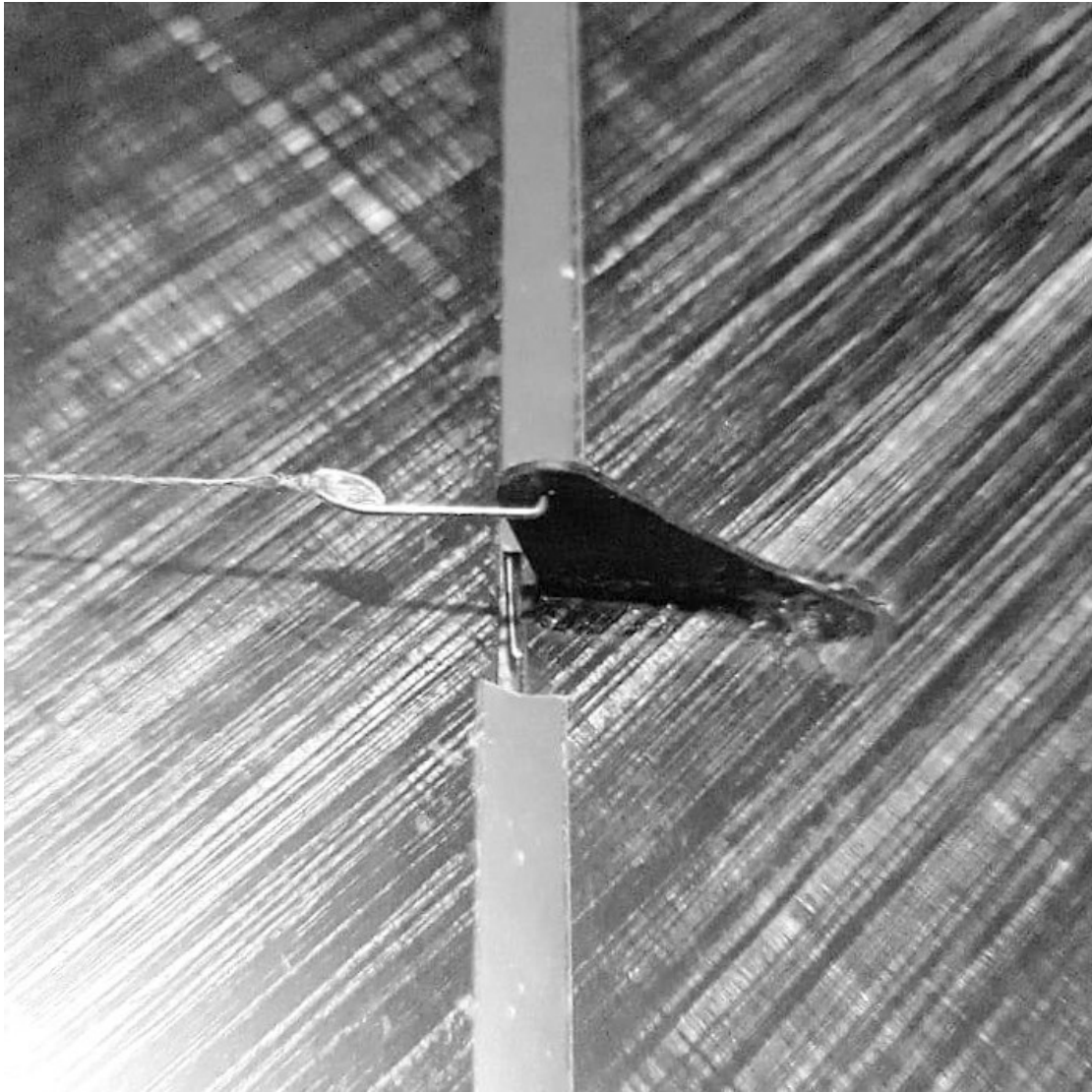
Petit crochet fin en Corde à Piano de 0.3 à 0.5 mm, relié au fil
