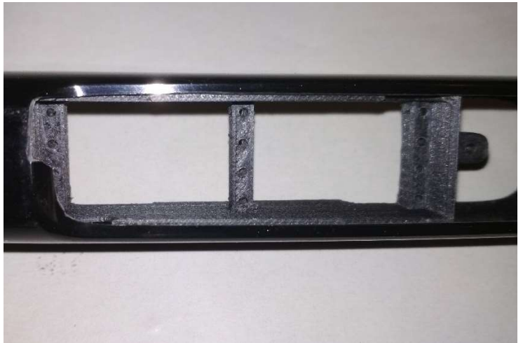
Echancrure découpée sur la lèvre antérieure pour permettre une pose facile du 4 eme servo (empennage)
