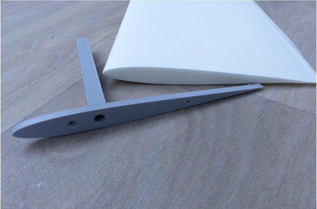
Afin de faciliter la construction d'une aile de Pixel en extrudé coffré, nous proposons une solution technique : rapporter une nervure d'emplanture qui inclue le pion d'incidence, le perçage du crocher de fixation des ailes et la boîte à clef d'aile qui donne le dièdre et le bon alignement des emplantures
