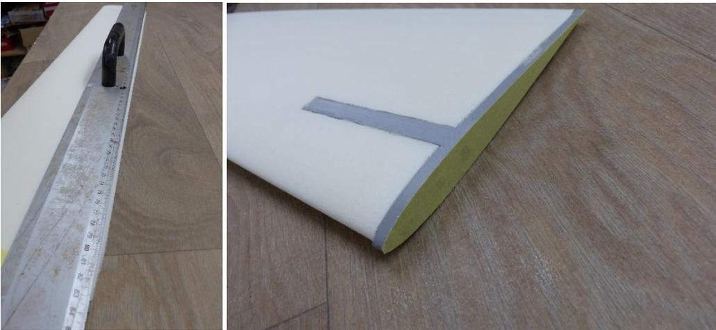
Les renforts des ailes sont positionnées sur les coffrages au niveau des emplantures et du bord d'attaque avec le ruban verre de 20mm
