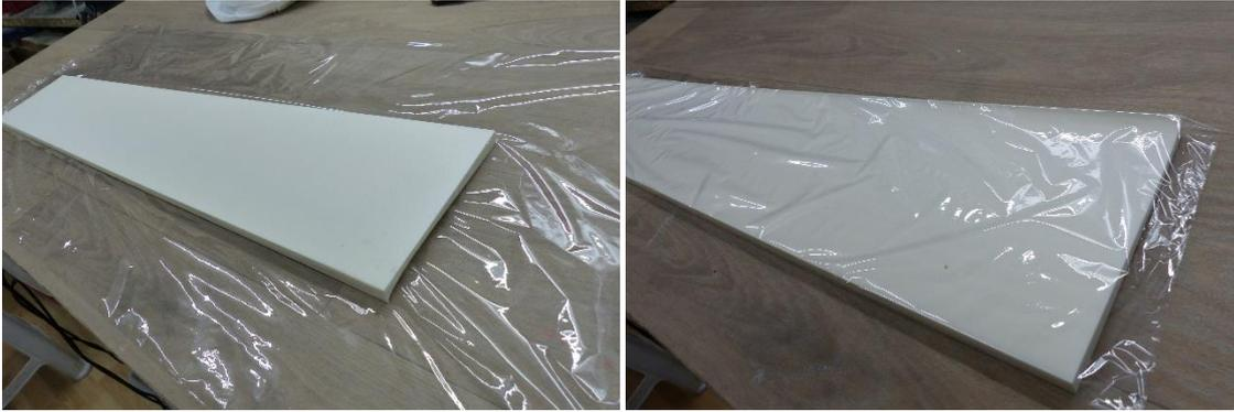
Le bord de fuite de l'aile est recoupé avec un cutter et la nervure est protégée par un adhésif papier
