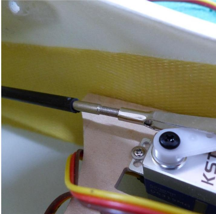
Les commandes de profondeur et dérive sont raccordées au servos par une chape M3 et son embout fileté collé à l'époxy dans le tube carbone
