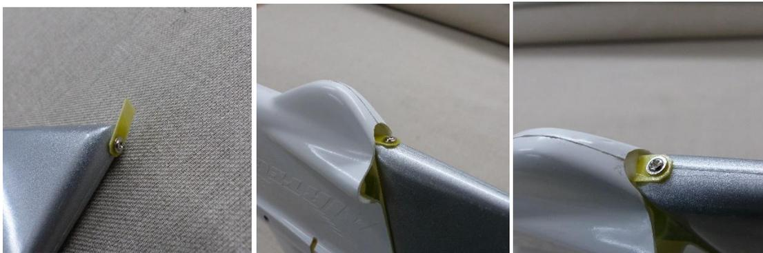
La languette en époxy 6/10 est façonnée, percée à 1.5mm et sera collée à l'époxy
