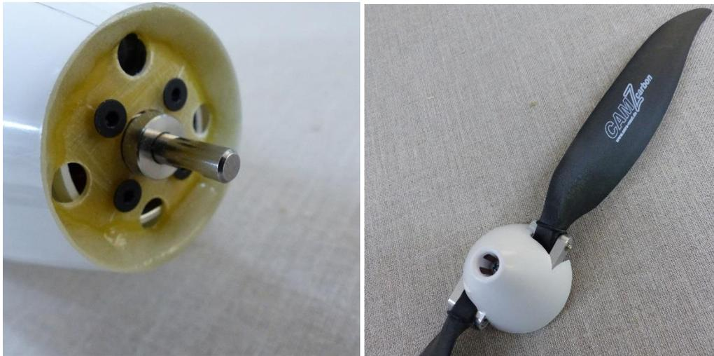
Si le cône est ventilé, autant faire des trous dans le couple moteur pour y faire passer l'air frais. Un congé à l'époxy est nécessaire pour un bon collage du couple
