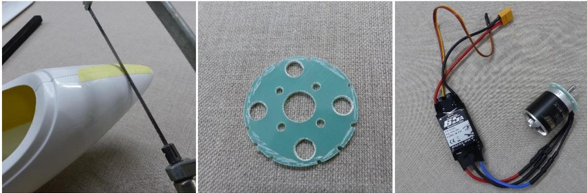
Le nez du Fizz est parfaitement cylindrique pour des cones de 38 à 42mm de diamètre, le nez se coupe à la scie à métaux en avant du bon diamètre puis on le ponce avec une cale pour approcher le diamètre du cone.
