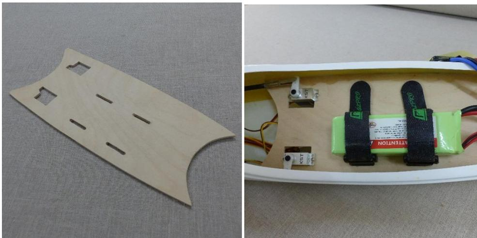
La platine en ctp permet de recevoir les servos, le contrôleur et la batterie sanglée. Les sangles doivent être passées dans la platine avant son collage.
