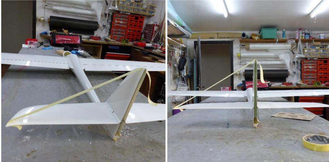
Pour coller correctement le tube, il faut monter les ailes sur le fuselage et aligner les empennages par rapport à l'aile. Surtout, bien laisser sécher l'époxy et ne démonter qu'une fois le collage bien sec. On apprécie au passage que la dérive soit démontable...
