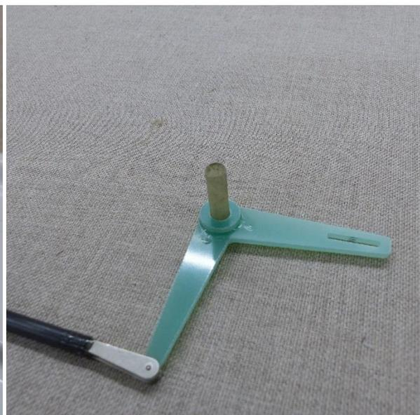
Le renvoi de profondeur est articulé autour d'un tube de fibre de 6mm extérieur qui sera collé dans la partie fixe de dérive. Pour que le collage soit facile et efficace, il est utile de chanfreiner le trou de 6mm, la colle trouvera sa place dans ce chanfrein.
