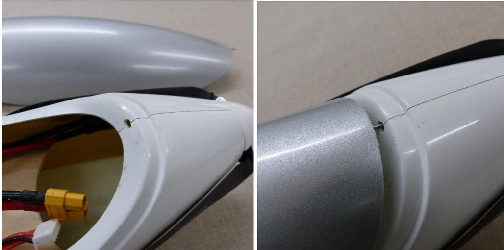
Pour verrouiller la verrière, il faut sur lavant faire une petite saignée pour que la cap 15/10 puisse rentrer dans le fuselage sans avoir à forcer et à repousser trop en arrière la verrière.
