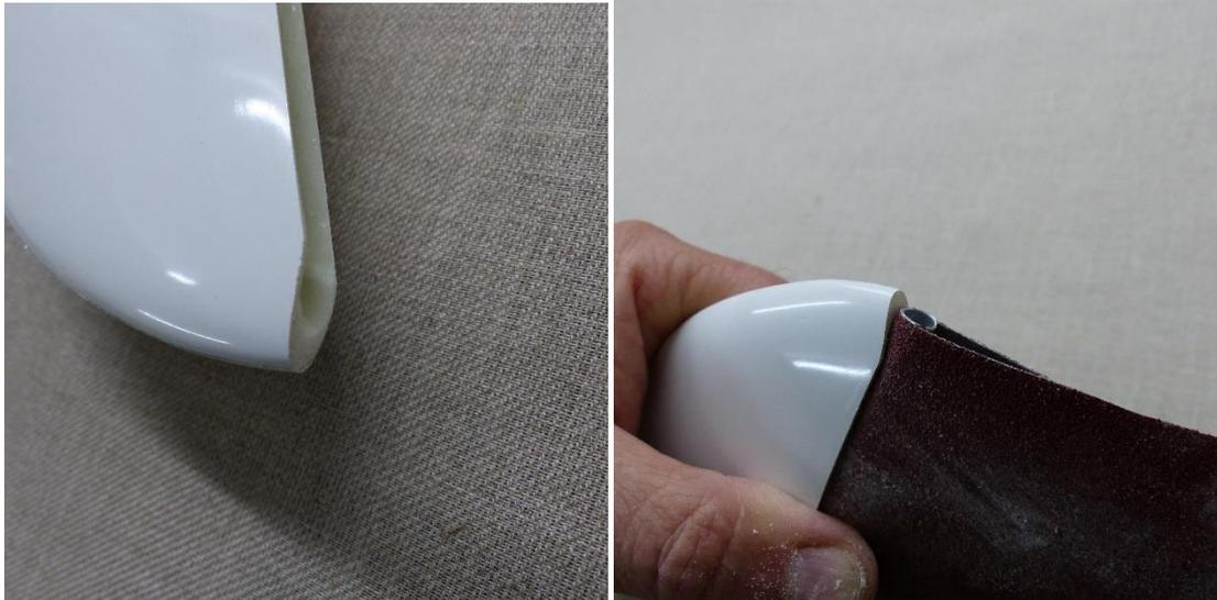
La partie fixe de dérive doit être poncée en biais et arrondie par l'intérieur pour que la partie mobile puisse bien s'articuler.
