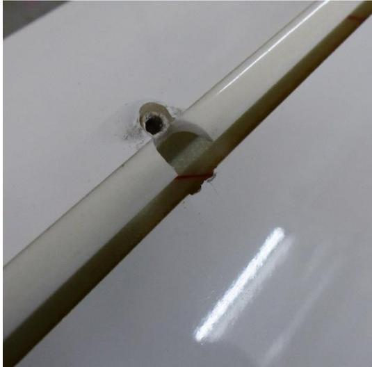
La lèvre des volets doit être fraisée pour que la commande ne touche pas la lèvre
