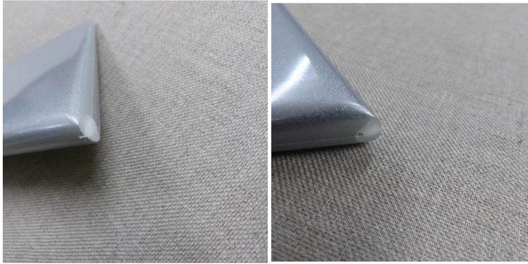
La partie basse de la dérive est poncée, faire un plat et percer un trou de 1.5mm pour la vis d'articulation
