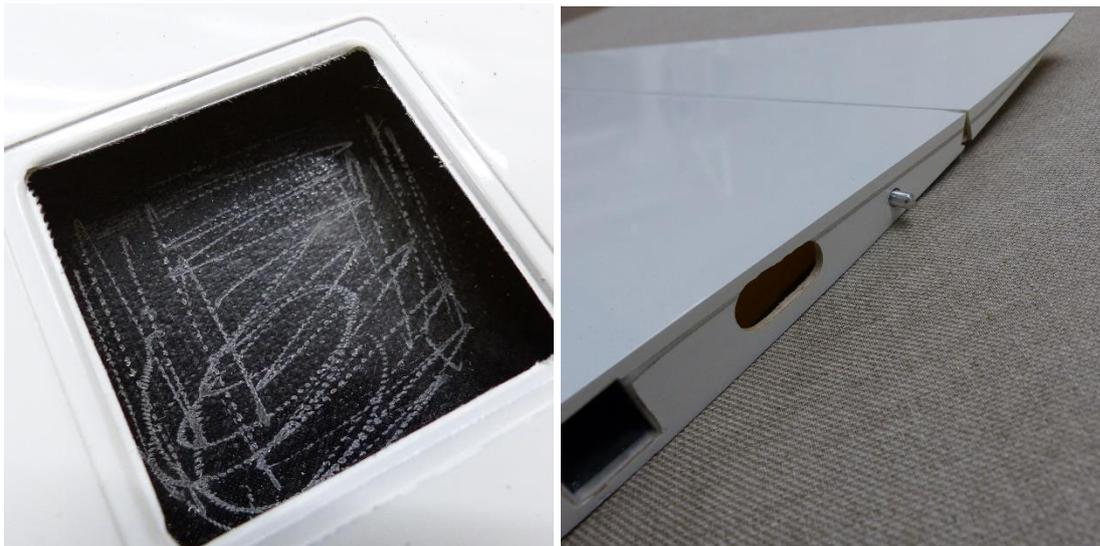
Avant de commencer, il faut dépolir les emplacements des servos et agrandir le trou au niveau de l'emplanture qui permettra de faire passer les rallonges et le connecteur
