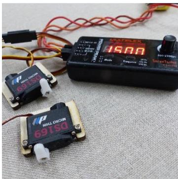
Pour les ailerons, on utilise le premier trou du bras de servo, neutre à 1500, bras le plus perpendiculaire possible au servo
