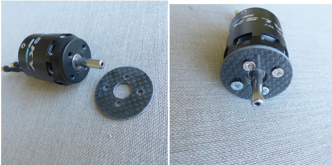
Le couple est vissé sur le moteur, ce couple va obturer le bout du fuselage..Donc une aération est nécessaire :
