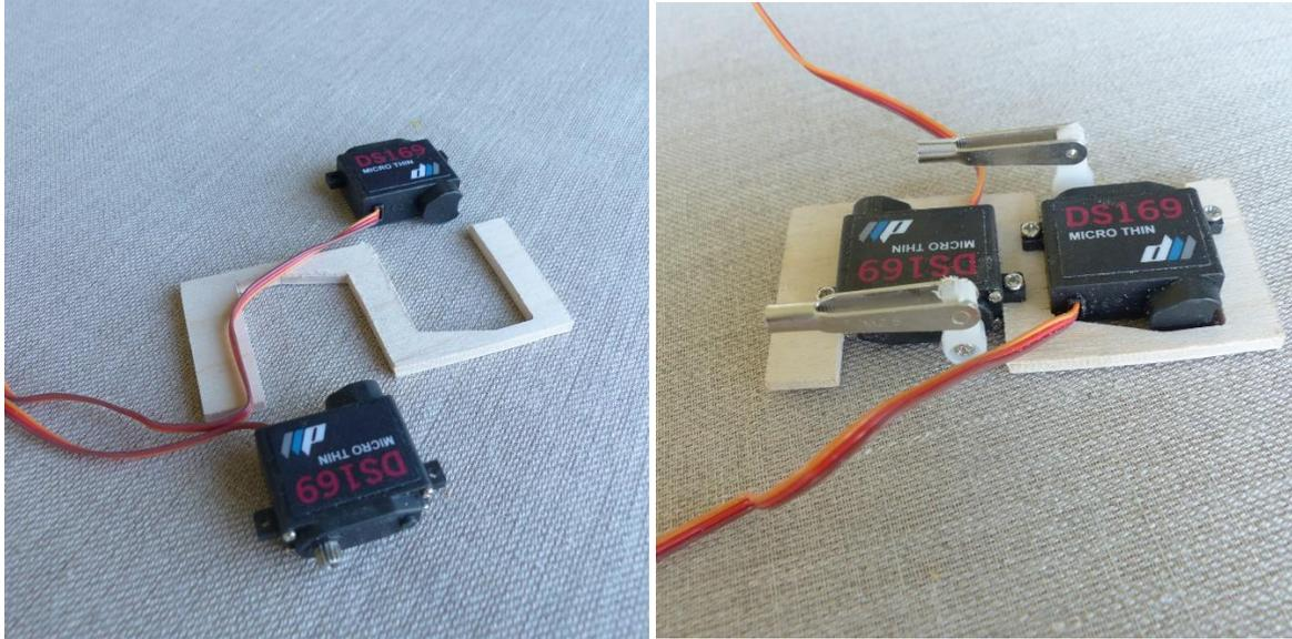
On utilise de 2eme trou de palonnier pour la dérive et le troisième pour la profondeur + chapes M2.5 qui recevra la commande en carbone de 2mm. Le servo de dérive étant à environ 130mm du bout de la verrière. Avant de mettre en place la platine et ses servos, il faut recouper les gaines orange.
