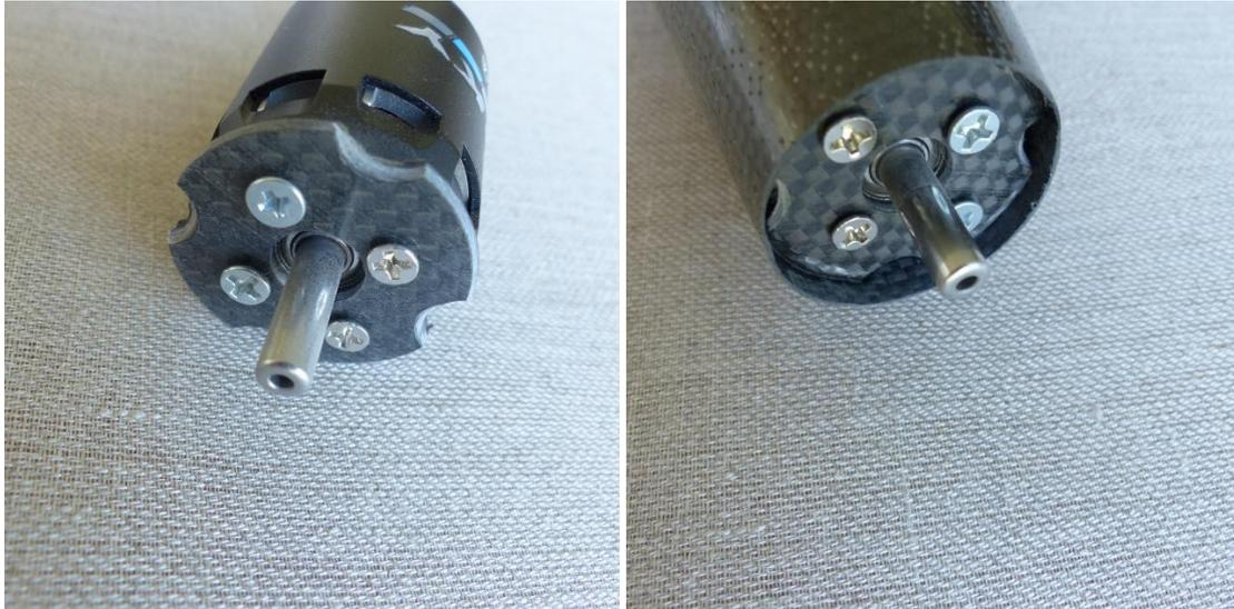
Comment bien coller le couple au bon endroit ? En retrait de quelques mm en arrière du bout du fuselage , mais c'est surtout le cône enfilé sur l'arbre qui va le mettre en bonne position. Un pointage à la cyano l'immobilise puis un mon collage à l'époxy + charge finira le travail.
