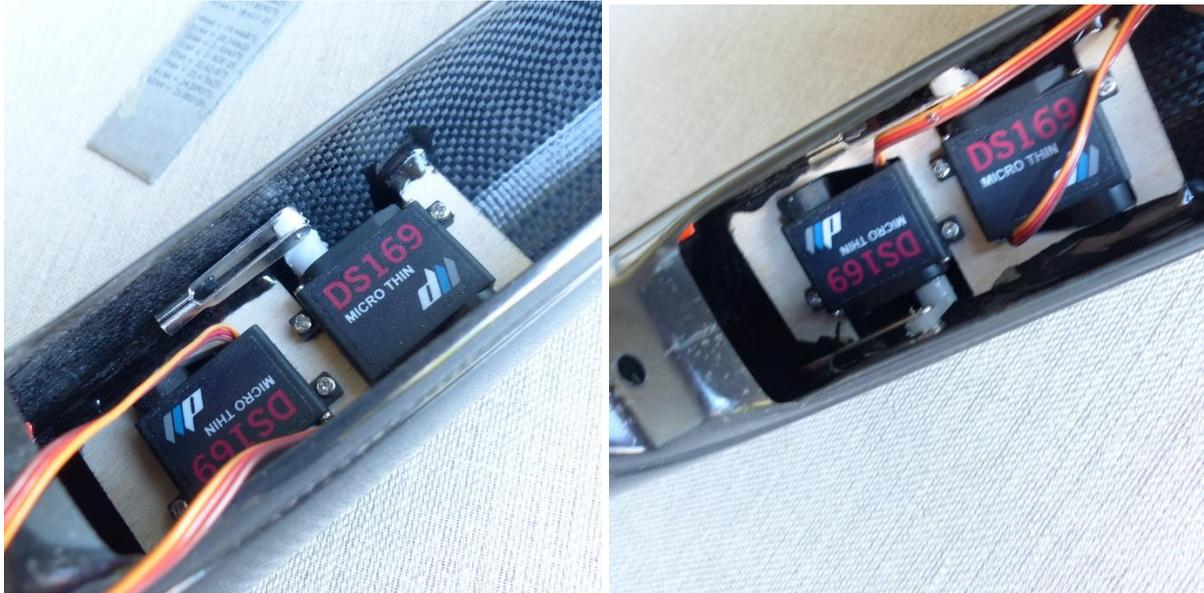
Les commandes en carbone de 2mm sont collées dans les capes M2.5.
