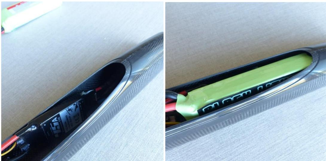
Le lipo 3S 1800mah peut avoir un battement de 50mm environ pour ajuster le centrage (110 à 115mm du bord d'attaque de l'aile)
