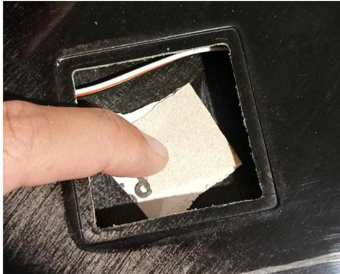
Etape 3 : Pour faciliter, le collage des pattes des LDS qui sont assimilés à des guignols, nous vous recommandons de découper légèrement la lèvre de fermeture. Pour pouvoir travailler facilement et sans prendre le risque la casser. Pour cela, il faut mesurer la largeur des pattes et ajouter de 1.5mm de part et d'autres. Pour trouver la position de les pattes, assembler les pattes avec le bras. De manière générale le bras se trouve à environ 4 à 5mm d'un côté de la trappe de servo.
