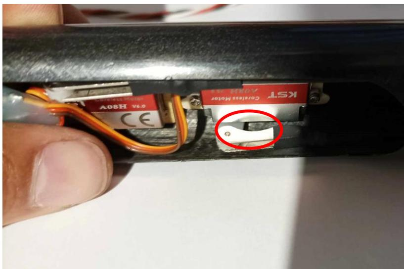
5eme étape : Coller les cadres servos afin que les chapes soient dans l'axe des joncs carbonés des commandes. Nous recommandons un collage à la colle Epoxy ou à la résine Epoxy chargée afin d'avoir le temps d'ajuster le collage.
