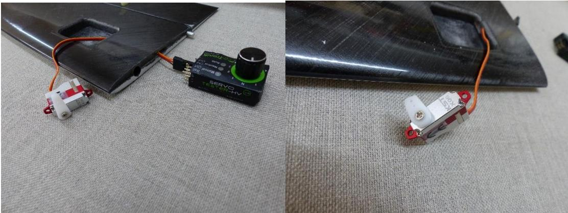
Au niveau du palonnier, le deuxième trou donne un débattement suffisant (percé à 1mm)
