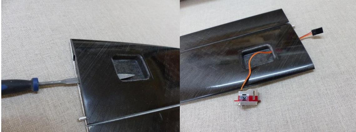
Le servo prendra place au milieu de l'emplacement avec une petite marge pour pouvoir le positionner au bon endroit au dernier moment, ce qui permettra de faire le neutre de la gouverne
