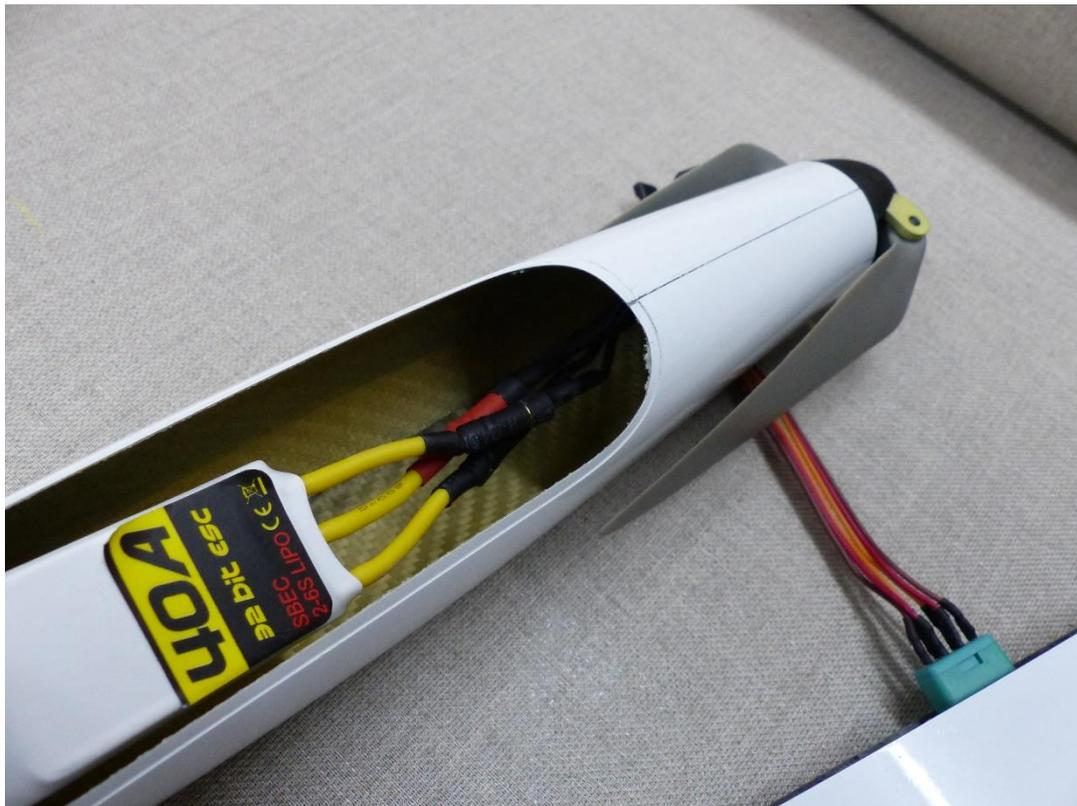
Pour obtenir un CG à 85mm du BA, il faut une batterie 3S en 1300mah. Le contrôleur trouve sa position au-dessus de la batterie.
