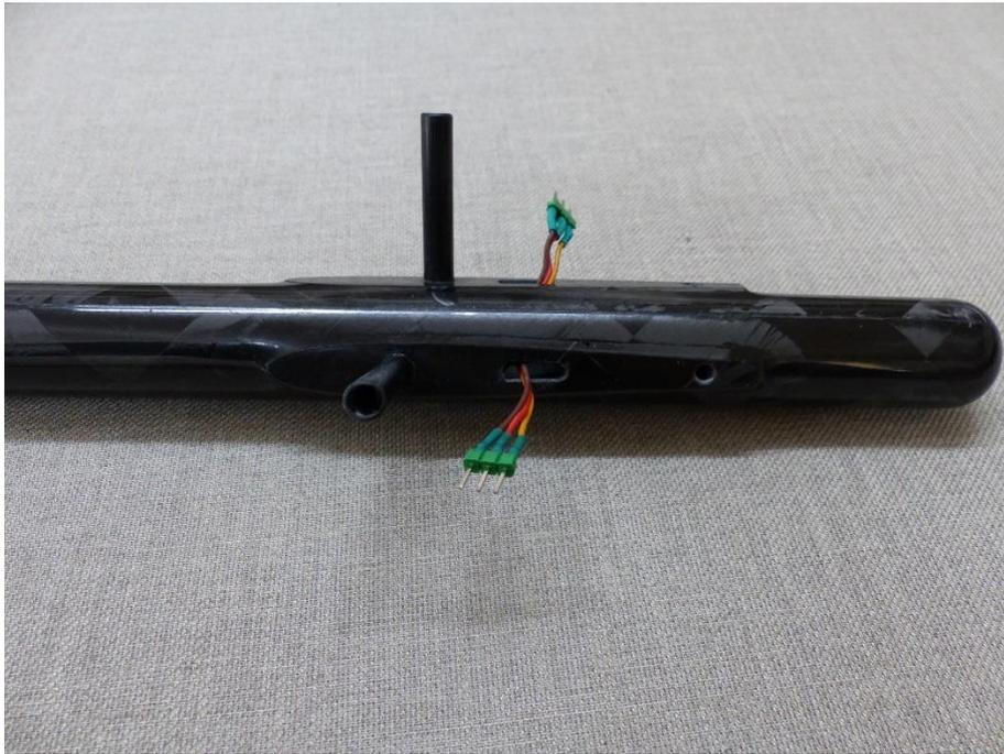
Les broches mâles seront collées dans la poutre : brancher les prises sur les empennages, préparer un peu d'époxy 5mn, en mettre dans les trous rectangulaires et mettre les empennages en place.
